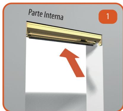
Posizionare il cassonetto al soffitto o appoggiarlo sulle guide e fissarlo con le viti alle pareti.
