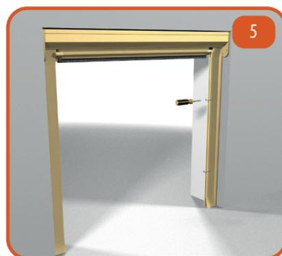
Fissare alle pareti le due guide laterali con le viti.
