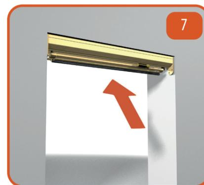
Posizionare il cassonetto al soffitto o appoggiarlo sulle guide laterali (profili esterni guide telesc.) e fissarlo con le viti alle pareti.
