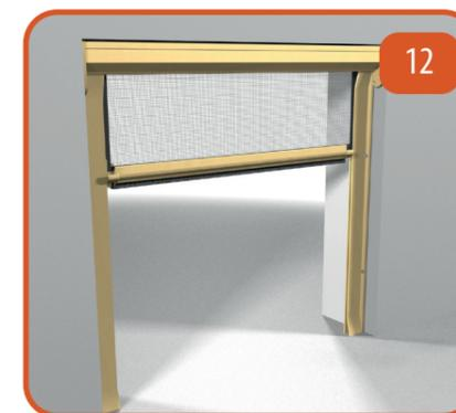
Collaudare la zanzariera. Nella versione con guide telescopiche la barramaniglia si aggancia in basso ai piedini attraverso una leggera rotazione, nella versione Quick-Lock invece l'aggancio avviene premendo la barramaniglia dall'alto (premendola nuovamente per lo sgancio).
